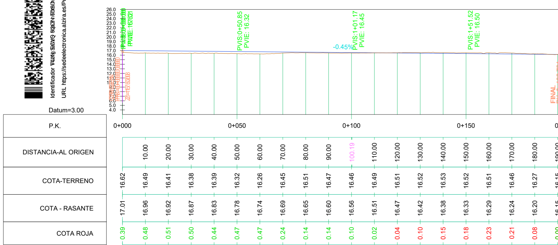
Perfil Longitudinal: Alineación_LLIMONERS(12) Escalas - H:250 V: 125
