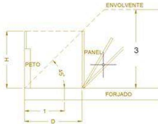
*En los casetones del ascensor, acceso a la cubierta, otras instalaciones y trasteros, se situarán siempre coplanarios en horizontal y a una altura máxima del forjado de 20 cm.*
