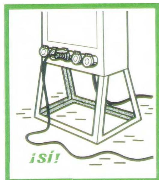
Hay que proteger al máximo las canalizaciones eléctricas contra los riesgos de aplastamiento, cizalladura, cortes, etc..., Debe remplazarse todo cable estropeado..
