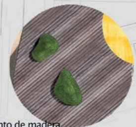
1. Pavimento de madera tratada en autoclave para uso exterior
