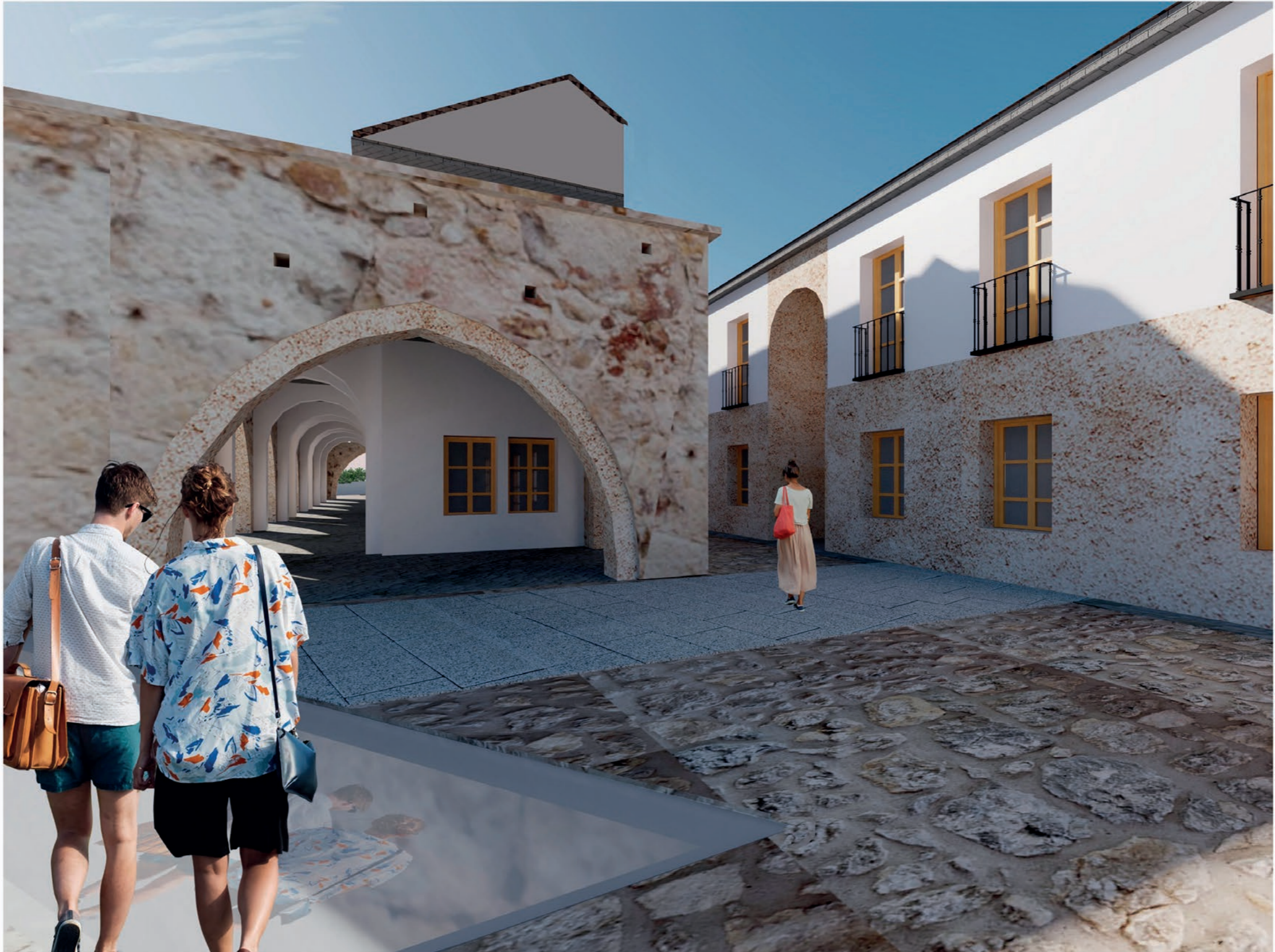
Vista desde el Punto de inicio de la nueva rampa que desciende hacia el parque Arabia Saudí la captura de la imagen enfoca la vista hacia las galerías del Bloque 1, vemos sobre el piso una franja de vidrio templado de alto tráfico que permite ver parte de la muralla enterrada
