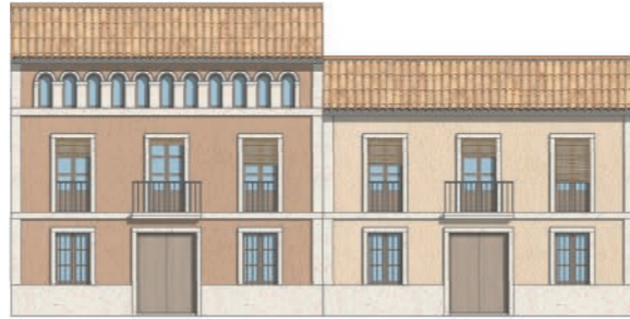
Fachada principal 1:100 Casa a dos mans longitud de fachada 7-9m - profundidad 7-10m con dos crujeas
