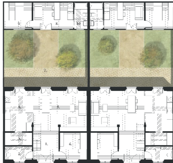
Planta baja 1:100 Casa a dos mans longitud de fachada 7-9m - profundidad 7-10m con dos crujeas
