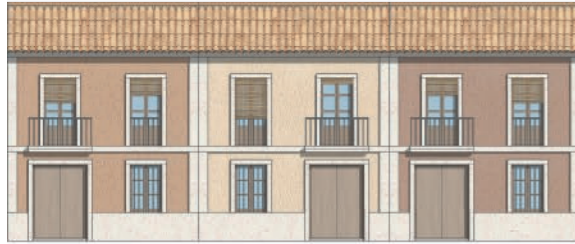
Fachada principal 1:100 Casa a una má longitud de fachada 5-7m - profundidad del cuerpo principal 7-10m con dos crujeas
