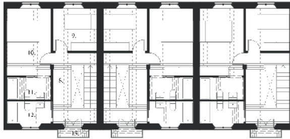
Planta alta 1:100 Casa a una má longitud de fachada 5-7m - profundidad del cuerpo principal 7-10m con dos crujeas
