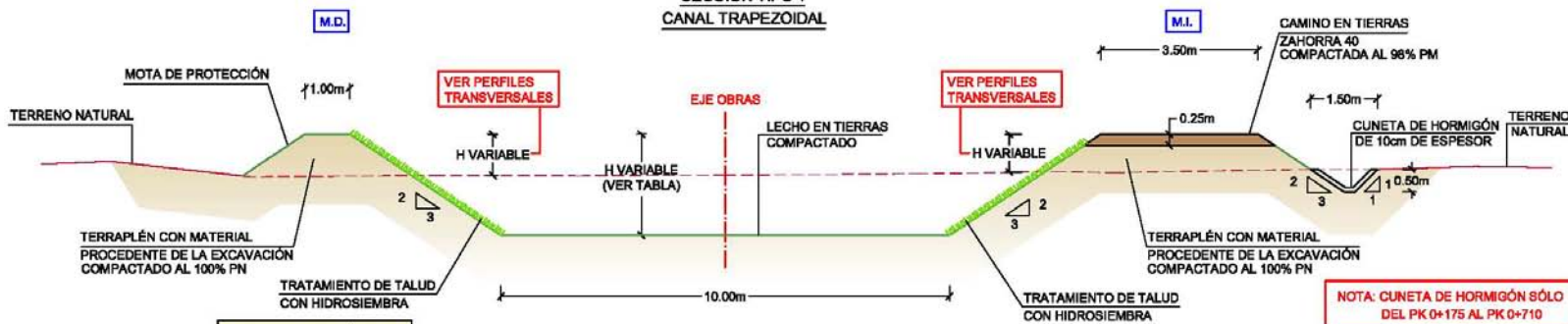
SECCIÓN TIPO 1 CANAL TRAPEZOIDAL
