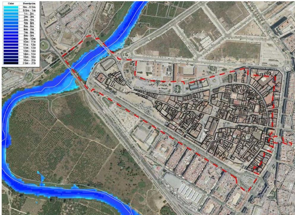
Según la cartografía no existe riesgo de inundación dentro del ámbito de la Vila. Para este periodo de retorno los niveles de caldo se producen en el propio cauce del río.
